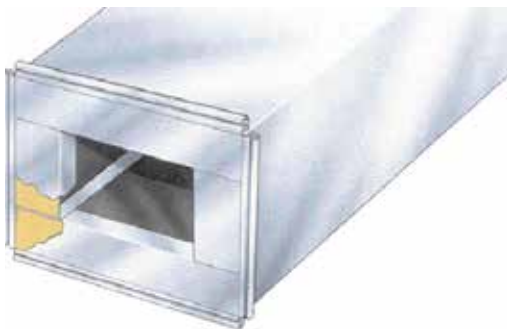
Montering av isolering utan krav på brandteknisk klass.
