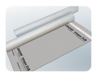
Die Unterdeckbahn Integra ZUB eignet sich für alle Steildächer mit harter Bedachung. Sie wird direkt auf die Wärmedämmung bzw. auf die Holzschalung aufgelegt. Bei Einhaltung der Regeldachneigung beträgt die Überlappung mind. 10 cm. Die beschriftete Seite ist nach oben gerichtet. Die Freibewitterung soll nicht über vier Monate hinausgehen. Bei der Verlegung sind die Fachregeln des Zentralverbandes Deutsches Dachdeckerhandwerk ZVDH zu beachten.
