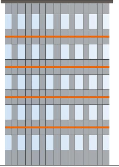
Der Brandriegel wird schnell und einfach zwischen allen Geschossen eines Gebäudes verlegt.
