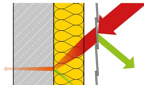
Schallwellen treffen in den Dämmstoff und reiben sich in der Wirrlage des Dämmstoffgefüges an den Fasern. Dadurch verwandelt sich ein erster Teil des Schalls (bzw. der mechanischen Energie) in Wärme.
