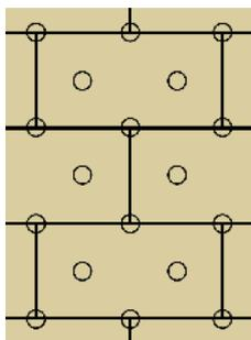
ISOVER Empfehlung zur Dübelanordnung bei Montage nach DIN 18516
