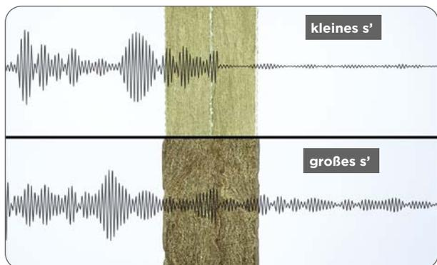
Akustic HWP 1 bietet durch seine **niedrige dynamische Steifigkeit** hervorragenden Schallschutz, der durch Zweilagigkeit nochmals verbessert wird.
