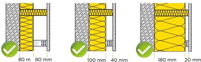
**Klemmfläche Dämmstoff zu Brandriegel  $< 50\%$ .
