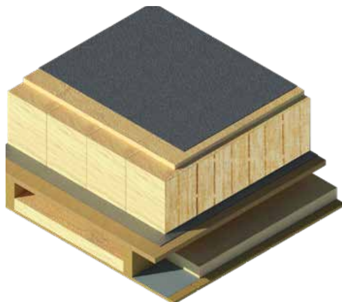
Fig. 17: Principkonstruktion på parallelltak
