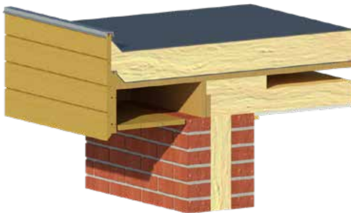
Fig. 18: Stängning av ventilationsöppningar vid tilläggsisolering.
